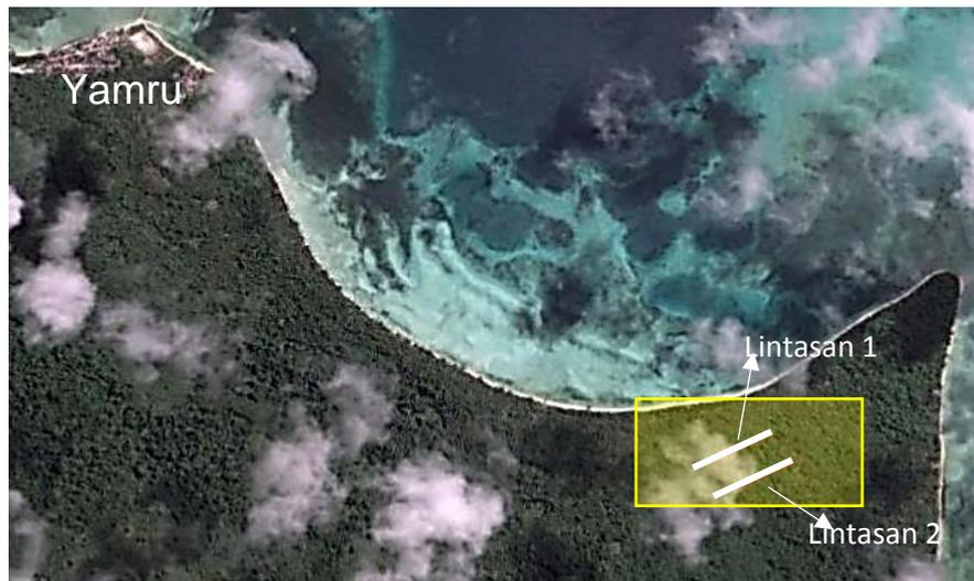
Gambar 5. Lintasan pengukuran geolistrik di pantai Kuber
