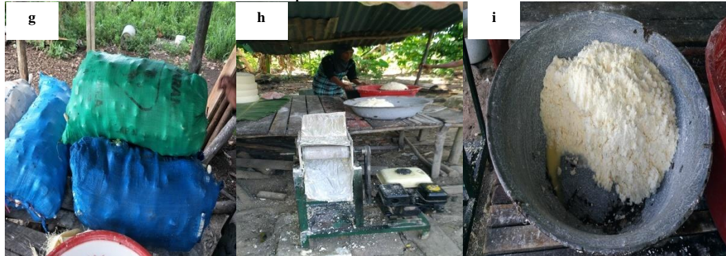
Gambar 3. Proses pengolahan: g) bahan baku singkong yang telah dibersihkan. Kemudian, dikemas dalam karung untuk diangkut dan diparut, h) setelah itu, bahan baku diparut dengan menggunakan mesin pamarut singkong, i) bentuk adonan serat ubi kayu sebagai bahan baku utama pembuatan gepe .
