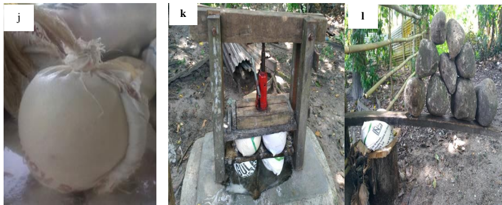
Gambar 4. Proses pengolahan: j) bahan baku yang telah dikemas dan siap untuk ditindih, k) proses pengepresan yaitu ditindih dengan menggunakan alat dongkrak yang masih sederhana, l) proses pengpresan masih dengan peralatan manual, yaitu dengan menggunakan batu sebagai alat pemberat, serat kemudian ditindih hingga mengeluarkan air.
